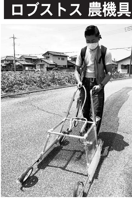
作物への飛散を防ぎつつ、幅を変えながら散布できるアジャスタブルスプレーヤ
